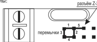
**Рис.1 Положения перемычки.**
